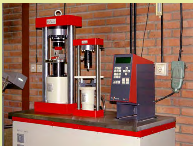
دستگاه یونیورسال، برای اندازه‌گیری مقاومت خمشی و فشاری ملات ماسه سیمان جهت کنترل کیفیت سیمان
