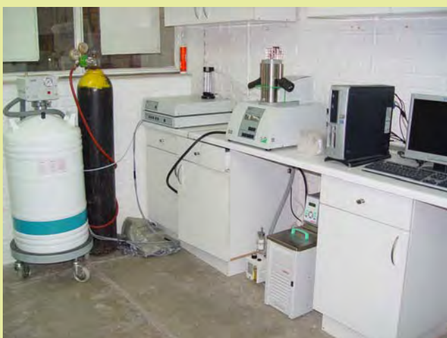
دستگاه (DSC) گرماسنج روبشی جزء به جزء، برای آنالیز حرارتی مواد
