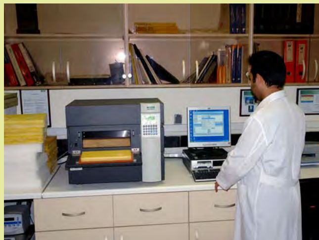
دستگاه جریان حرارت سنج برای اندازه‌گیری ضریب هدایت حرارتی
