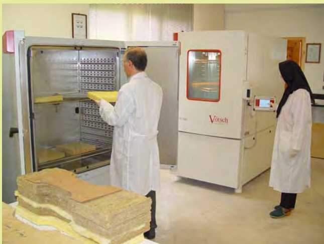
انجام آزمایش‌های خواص مکانیکی عایق‌های حرارتی مطابق استانداردهای ملی ایران
